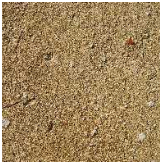
Vista ravvicinata di intonaco impastato con sabbia locale
